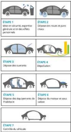
Schéma 1 : Les phases du processus de démantèlement d'un VHU.
