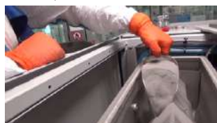
Figure 2 – Situations d'exposition aux poussières métalliques lors du rechargement de la machine
