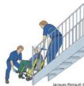
Figure 1 Transport d'un bénéficiaire en civière-chaîse (Stryker® Stair-PRO) par soulèvement dans les escaliers par un binôme de TAP (Corbeil et al. , 2017)
