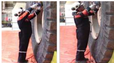
Figure 3. Mécanicien en changeant les pneus d'un gros camion d'extraction minière, sans et avec un exosquelette
