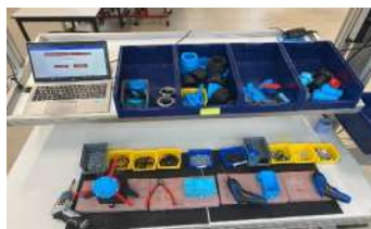
FIGURE 2 - UN POSTE DE TRAVAIL MANUEL DE DESASSEMBLAGE
