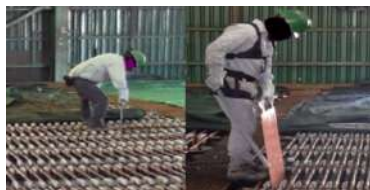
Figure 1. Opérateur chargé de l'inspection des circuits courts dans la raffinerie, sans et avec un exosquelette
