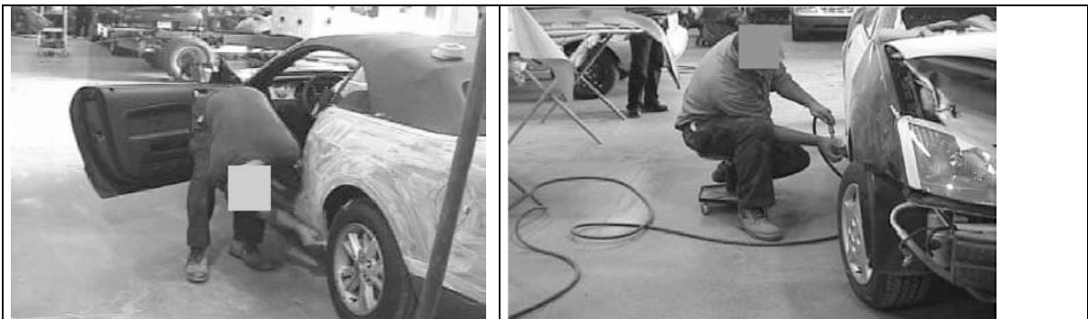
Figure 4. Exemples des postures utilisées lors du ponçage sans (à gauche) et avec un banc (à droite)
