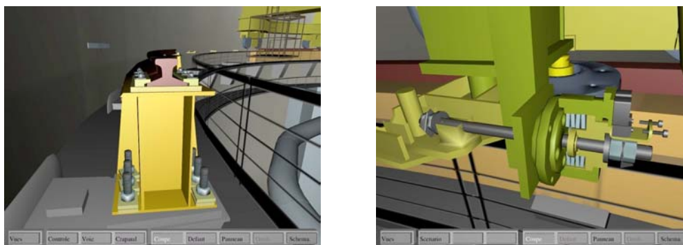
Figure 4 : Vues en coupe de la voie et du limiteur issues du projet Maintenance du Pont Polaire
